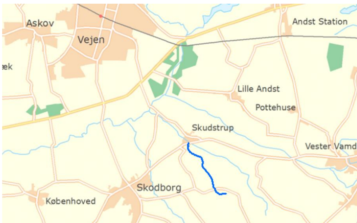
Figur 1.1. Den blå linje markerer den strækning af Bodil Aires Bæk på 2,5 km, der er omfattet af Vandområdeplanen 2015-2021. Strækningen er udpeget med en indsats, hvor vandløbet skal restaureres med udlægning af groft materiale.
